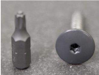
EQUITONE [materia] kann mit systemzugehörigen EQUITONE Universal-Fassadenschrauben mit Bohrspitze aus Edelstahl (A2-1.4567) mit Kopfdurchmesser 15 mm (Antrieb: Innenvielkant T20 mit Zentrierführung) auf einer Holz-Unterkonstruktion befestigt werden und sind in der jeweiligen Tafelfarbe oder in blank erhältlich.
